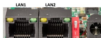
LAN2 порт размещен около переключателя и может быть включен в режим PoE Out для выдачи питания на сетевое устройство
