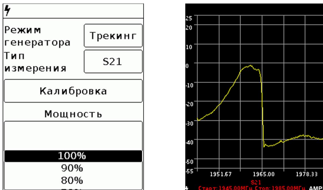
Рисунок 8.4.3 – Снятие АЧХ исследуемого оборудования
