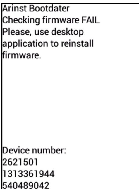
Рисунок А3.2 – Экран прибора при неудачной загрузке МПО (прошивке)
