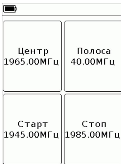
Рисунок 8.3.1 – Меню установки частотного диапазона
