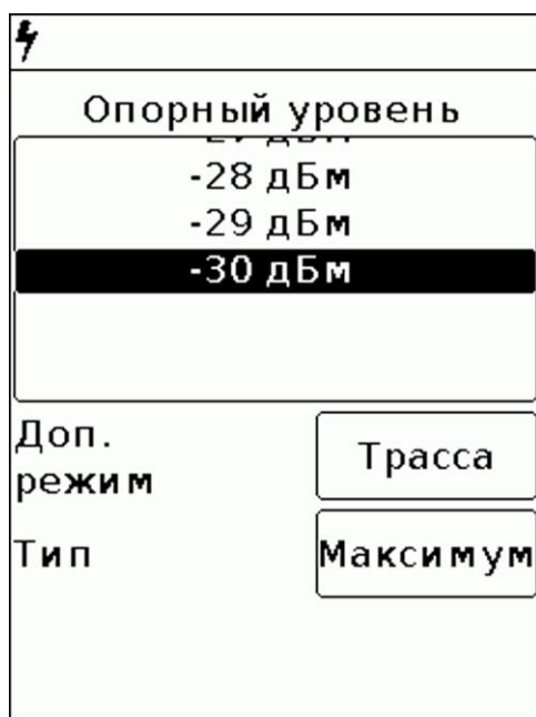
Рисунок 8.5.2 – Измерения в дополнительном режиме «Трасса Максимум»
