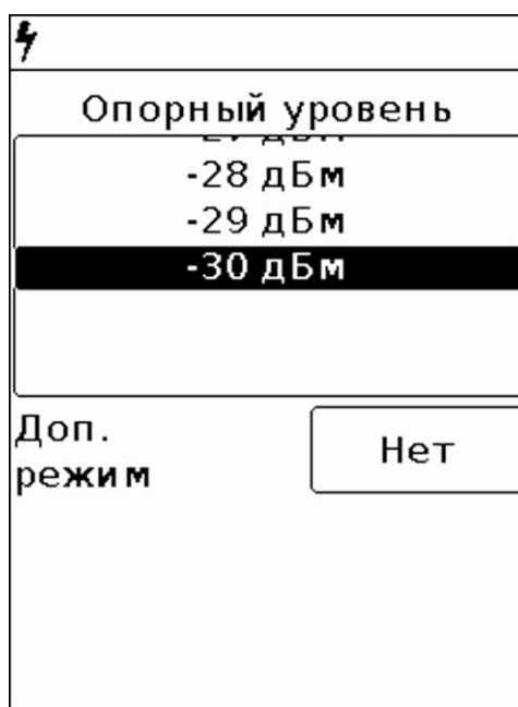
Рисунок 8.5.1 – Установка опорного уровня входного сигнала
